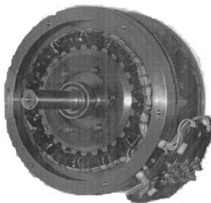
Рис. 1. Опытный образец вентильной индукторной электрической машины СГУ.
