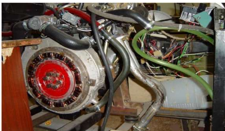
Рис. 2. Общий вид стенда со стороны размещения вентильной индукторной машины СГУ
